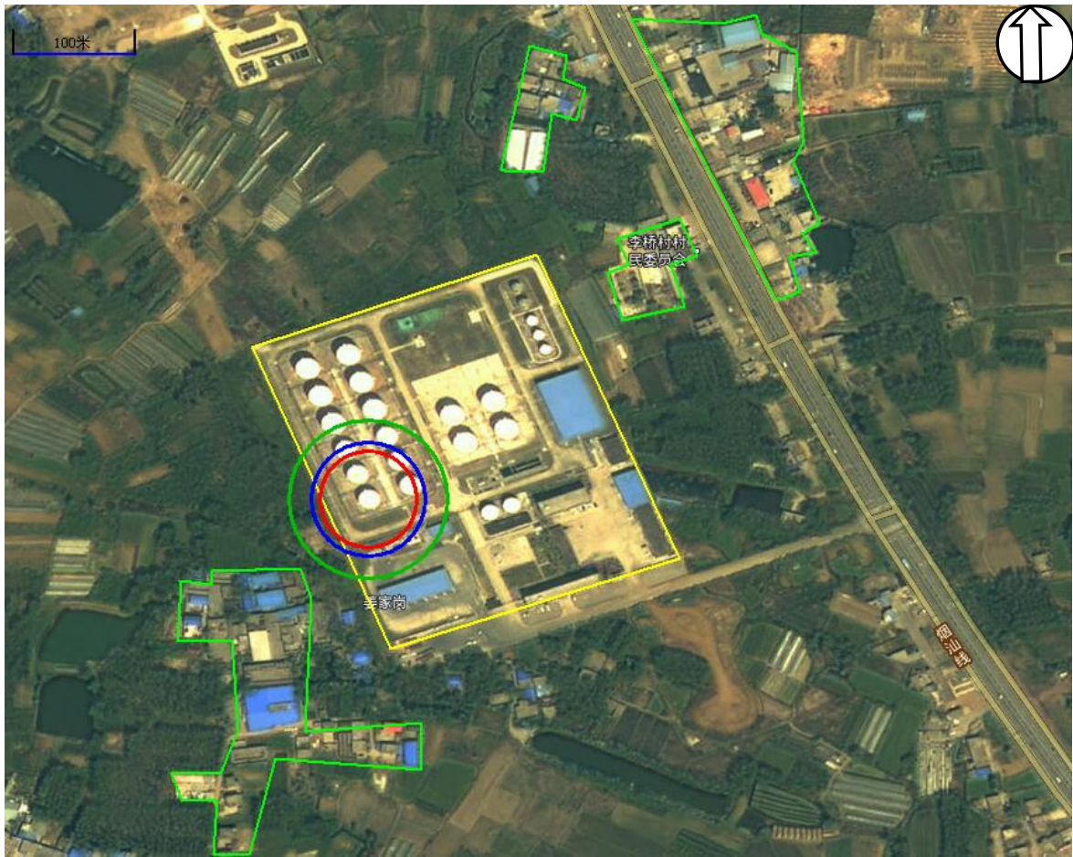
图 4.2-1 T 1 罐区 2#汽油储罐（管道大孔泄露）池火灾事故伤亡范围
