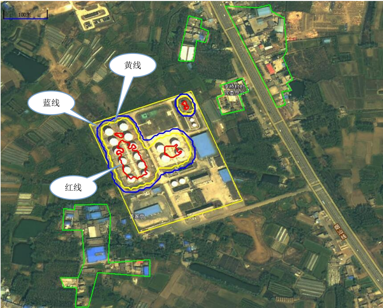
图 6.2 中石化淮南油库外部安全防护距离示意图
