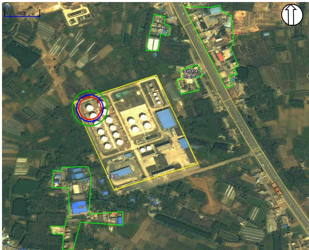
图 4.2-2 T 1 罐区 6#柴油储罐（管道大孔泄露）池火灾事故伤亡范围
