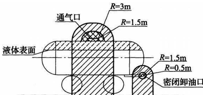
图 3-3 油罐车卸油时爆炸危险区域划分
