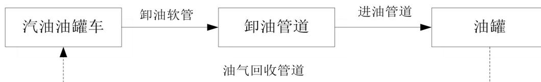
图 2-2 汽油卸油工艺框
