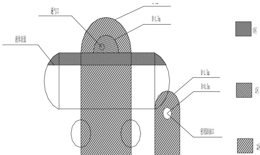
图 3-2 油罐车卸油爆炸危险区域划分
